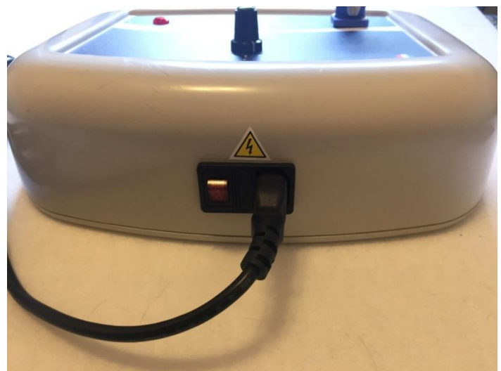
Ingresso cavo di alimentazione e interruttore ON/OFF
